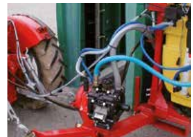
Knick- und hydraulische Lenkdeichsel (für enge Vorgewende)
