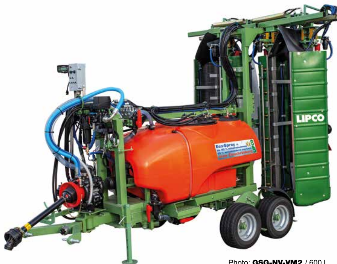
Photo: GSG-NV-VM2 / 600 l avec essieu oscillant tandem et monte pneumatique 195/55-R 10C
