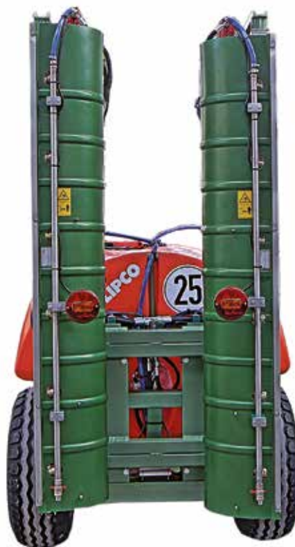
Photo: TSN-1 / 1.000 l – avec pneus standard 10.0/75-15.3 10PR
