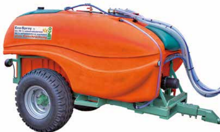
remorque réservoir 1.500 l monte pneumatique 11.5/80-15.3 8PR
