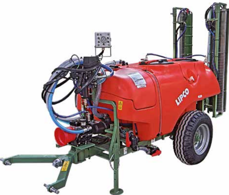
Photo: TSN-1 / 1.000 l – avec pneus standard 10.0/75-15.3 10PR
